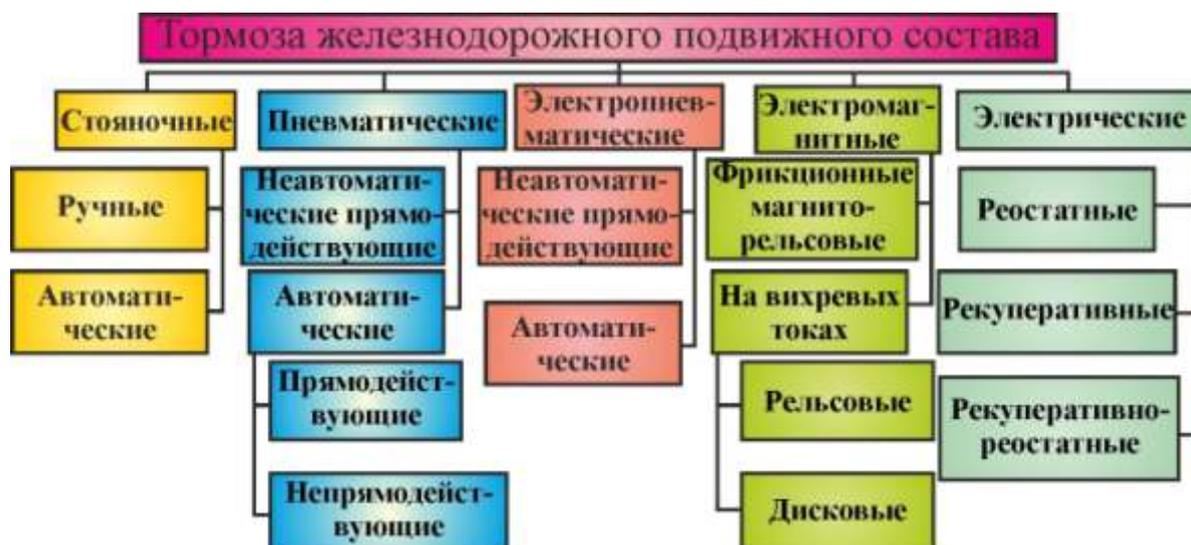
Рисунок 5. Примерная классификация тормозов подвижного состава.
