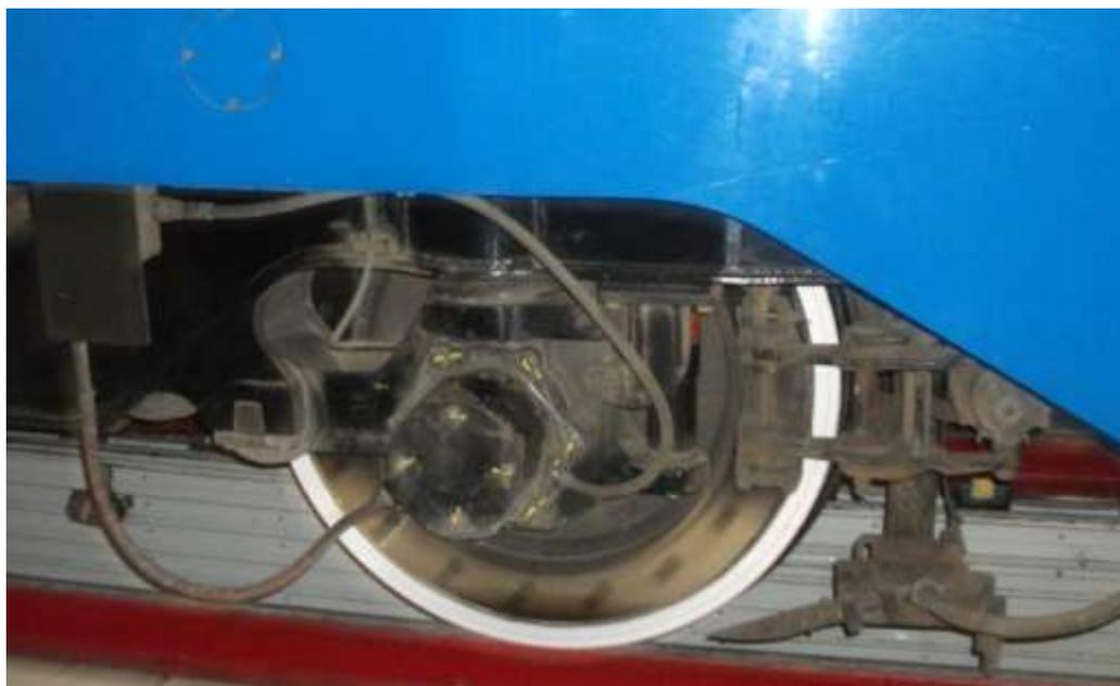
Рисунок 2. Пример расположения дискового тормоза на колесном диске.
