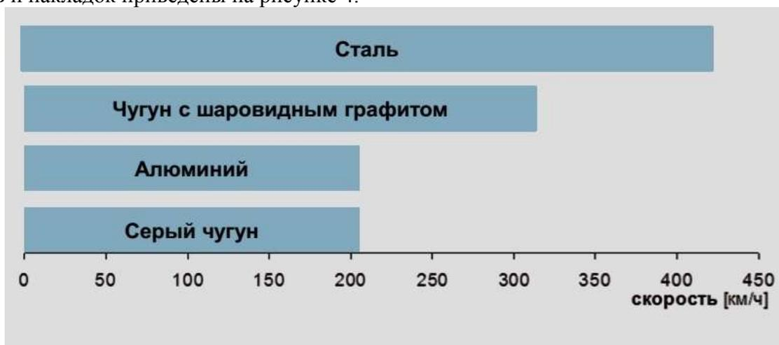
Рисунок 3. Материалы тормозных дисков для различных видов подвижного состава.
