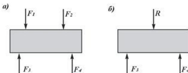
Рис.10.1. Система сил. а – заданная система сил; б– эквивалентная система сил
