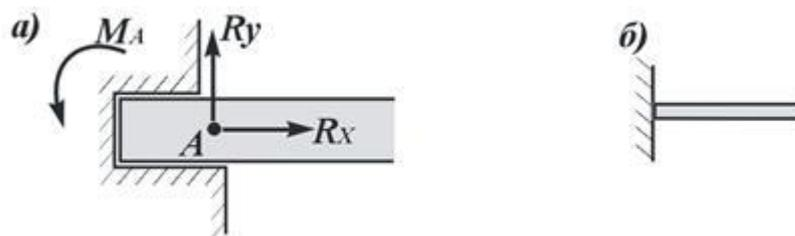
Рис. 22. Жесткая заделка: а – вид жесткой заделки; б – расчетная схема жесткой заделки
