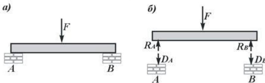
Рис. 15.1. Опирание балки на опоры:  $a$  – схема загрузки балки;  $b$  – силы действия балки на опоры и противодействия со стороны опор на балку
