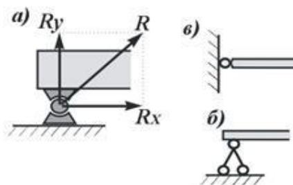
Рис.21. Шарнирно-неподвижная опора: а – вид шарнирно-неподвижной опоры; б, в – расчетные схемы шарнирно-неподвижных опор
