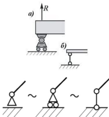
Рис.20.1. Шарнирно подвижная опора: а – вид катковой опоры; б – расчетная схема шарнирно-подвижных опор
