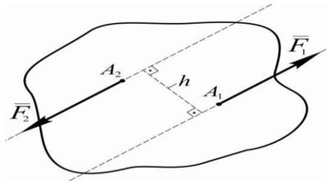
**Парой сил** называется две равные по модулю параллельные, но противоположно направленные силы.  $(F_1, F_2)$  - пара сил.
