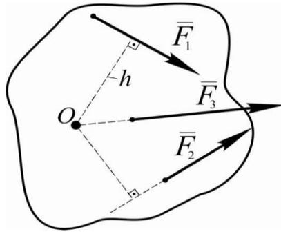
Очевидно, что в этом случае эффективность действия силы будет зависеть от модуля силы  $F_1$  и кратчайшего расстояния от линии действия силы до центра т. О.
