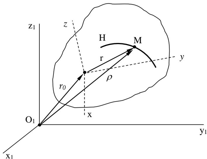
Первое движение (относительно подвижной системы отсчета) называется *относительным*, а второе движение точки  $M$  (вместе с телом  $H$ ) – *переносным*. Два этих движения порождают сложное движение точки  $M$ , которое по отношению к неподвижной системе отсчета называется *абсолютным*.
