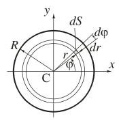
Воспользуемся полярной системой координат r,  $\varphi$ . Выделим элемент площади  $dS = r d\varphi dr$  массы  $dm = \delta dS = \delta r d\varphi dr$ . Элементарный момент инерции площадки  $dJ_{Cx} = dm(y^2 + z^2)$  включает в себя координату z, которой в силу малой толщины пластины можно пренебречь. Так как  $y = r \sin \varphi$ , то  $dJ_{Cx} = r^2 \sin^2 \varphi dm = \delta r^3 \sin^2 \varphi d\varphi dr$ .
