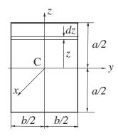
В первую очередь определим момент инерции пластины относительно оси Cy. Для этого выделим элементарную массу в виде полосы шириной dz, расположенной на расстоянии z от оси y. Тогда
