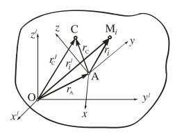
Проведем радиус-векторы  $\vec{r}_i$  и  $\vec{r}_i$ ', фиксирующие положение i-той точки тела в выбранных системах координат, и отметим положение центра масс C тела. Подставляя в соотношение  $\vec{r}_i = \vec{r}_i$ ' $-\vec{r}_a$ , окончательно получаем:
