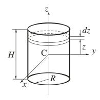
Сначала найдем момент инерции цилиндра относительно оси Cz, проходящей через его центр масс C. При выводе формулы (3.4) мы в рассуждениях не использовали толщину пластины. Поэтому, рассматривая прямой круговой цилиндр как однородную круглую пластину, сразу получаем:
