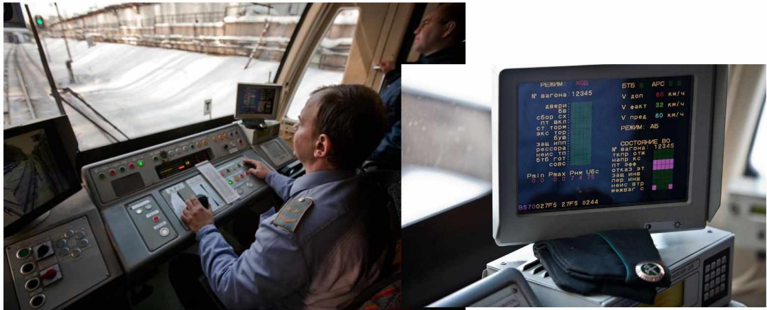
Рисунок 6 – Система автоматического регулирования скорости (АРС-АЛС)
