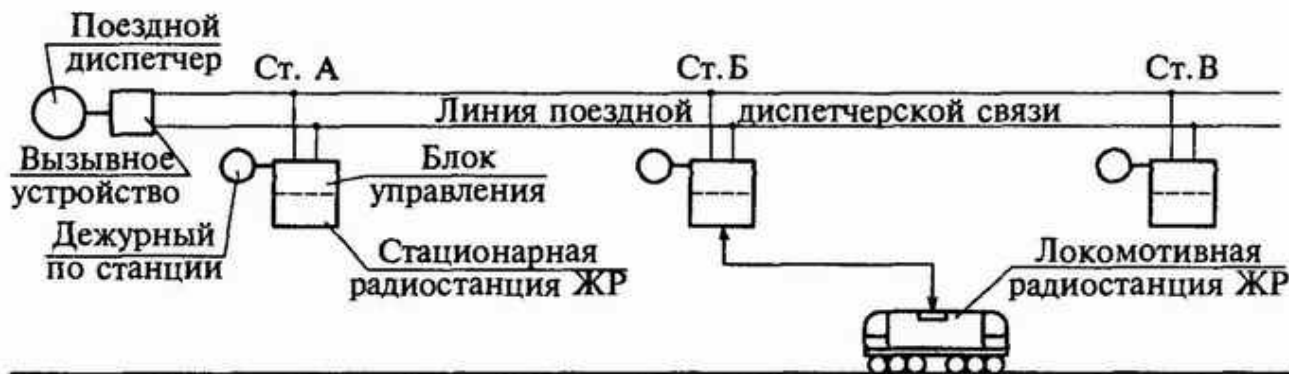
Рис. 7. Схема двусторонней поездной радиосвязи
