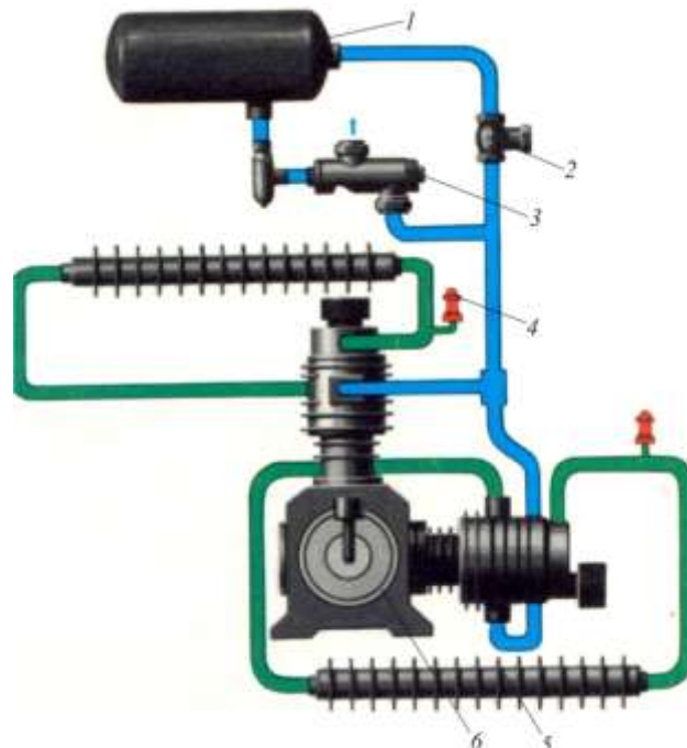
Рисунок 4.10. Схема соединений компрессора ВПЗ-4/9:
