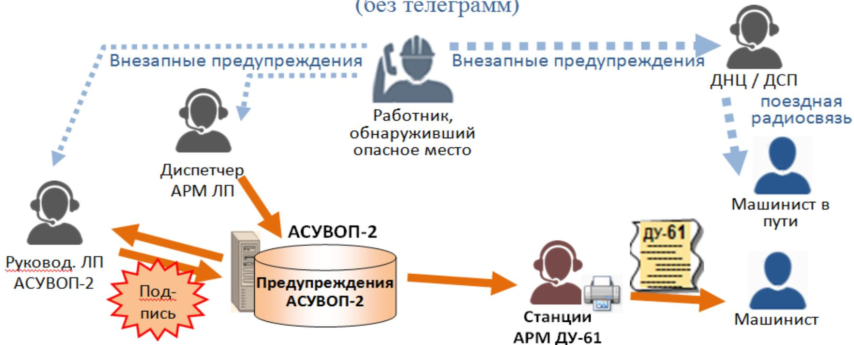
Автоматизированная система выдачи и отмены предупреждений (АСУВОП-2) является подсистемой управления движением поездов и обеспечивает выдачу, отмену предупреждений по всем хозяйствам. АСУ ВОП предназначена для организации электронного документооборота, включающего оформление заявки на предупреждения в дистанциях пути, а также ЭЧ и ШЧ, формирование бланков предупреждений в дорожном технологическом центре и выдачи предупреждений локомотивным бригадам на станциях.
