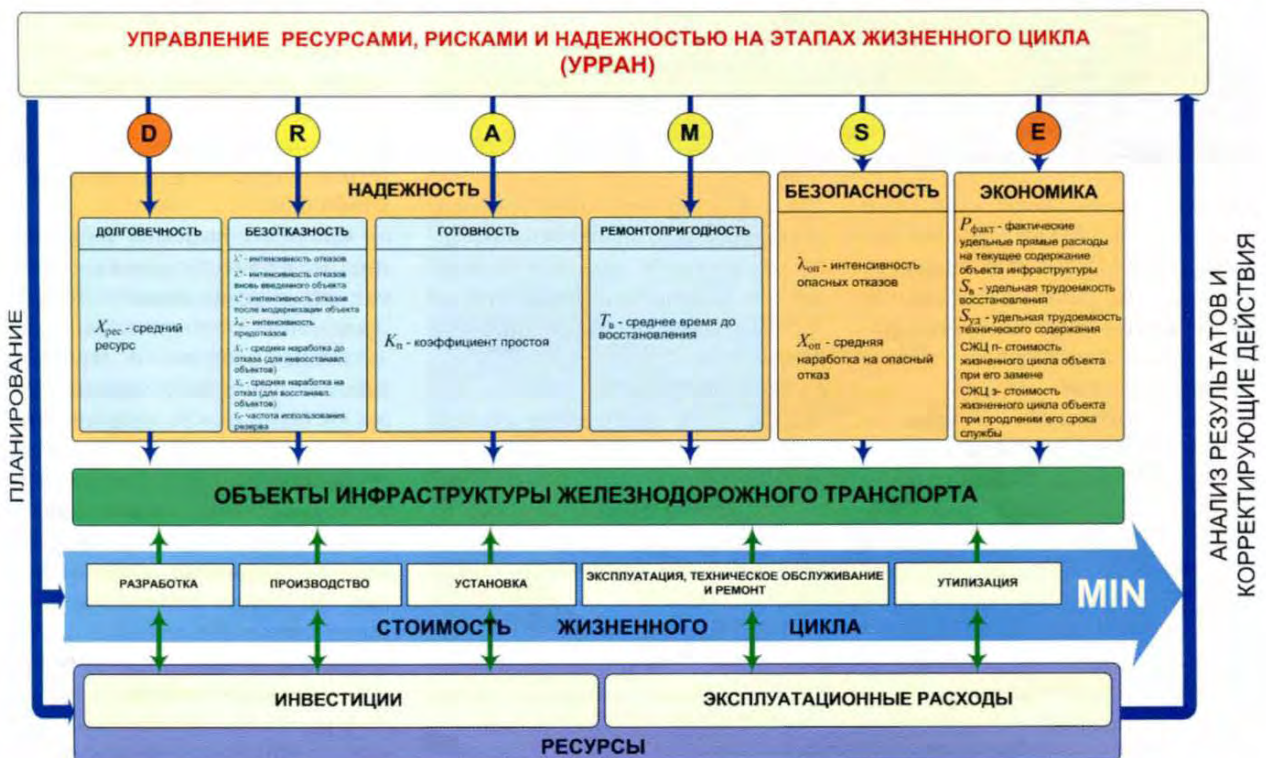
Рис. 1. Комплексное управление ресурсами, рисками и надежностью на этапах жизненного цикла объектов железнодорожного транспорта
