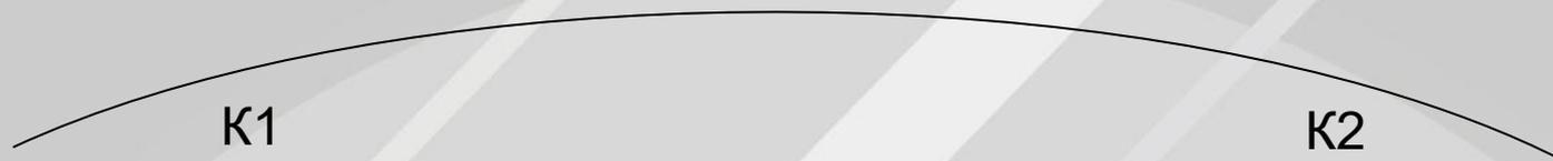
Станции, разъезды и обгонные пункты с продольным и полупродольным расположением приемоотправочных путей в трудных условиях допускается располагать на *обратных кривых*, но при этом пути каждого из направлений движения в пределах их полезной длины должны располагаться на кривых, обращенных в одну сторону.
