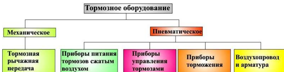
Рисунок 1. Функциональная классификация тормозного оборудования подвижного состава.
