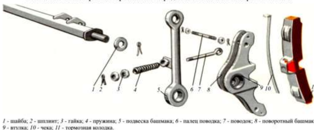
Рисунок 12. Детали тормозной рычажной передачи пассажирского вагона.
