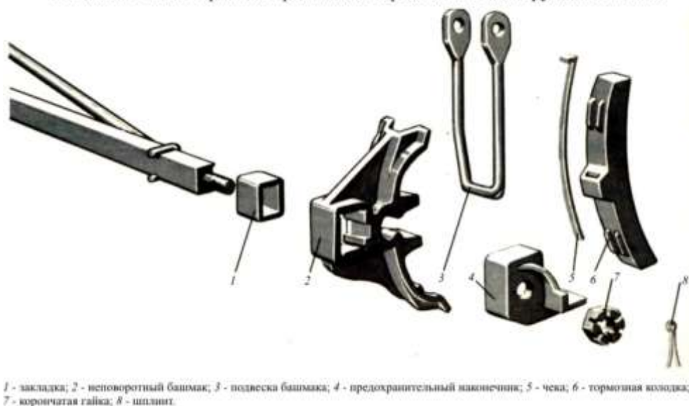
Рисунок 13. Детали тормозной рычажной передачи грузового вагона.
