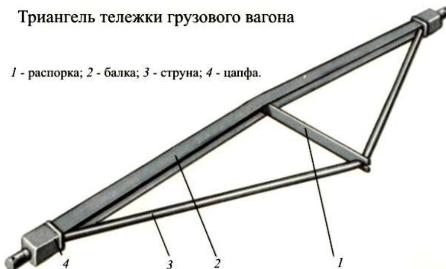
Рисунок 15. Триангель грузового вагона.
