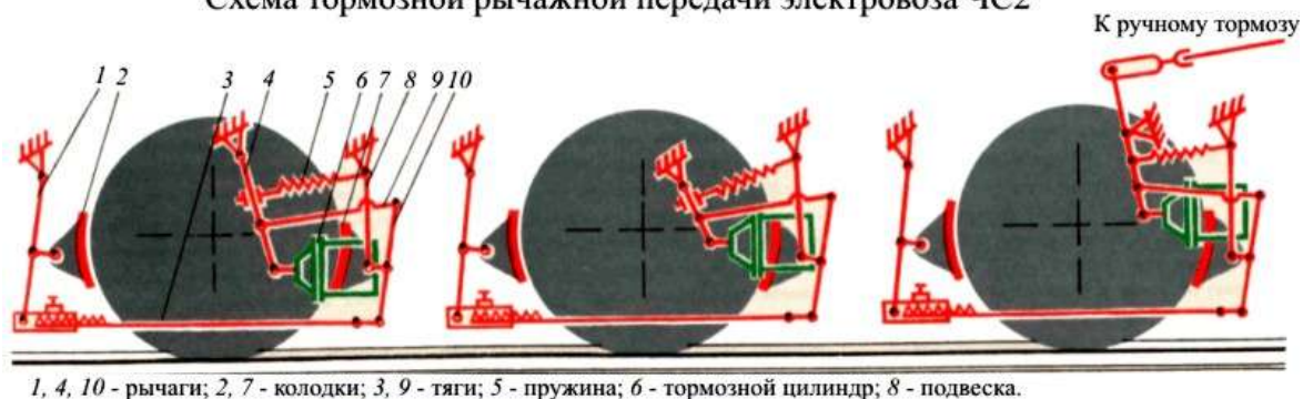
Рисунок 9. Тормозная рычажная передача электровоза ЧС2т.
