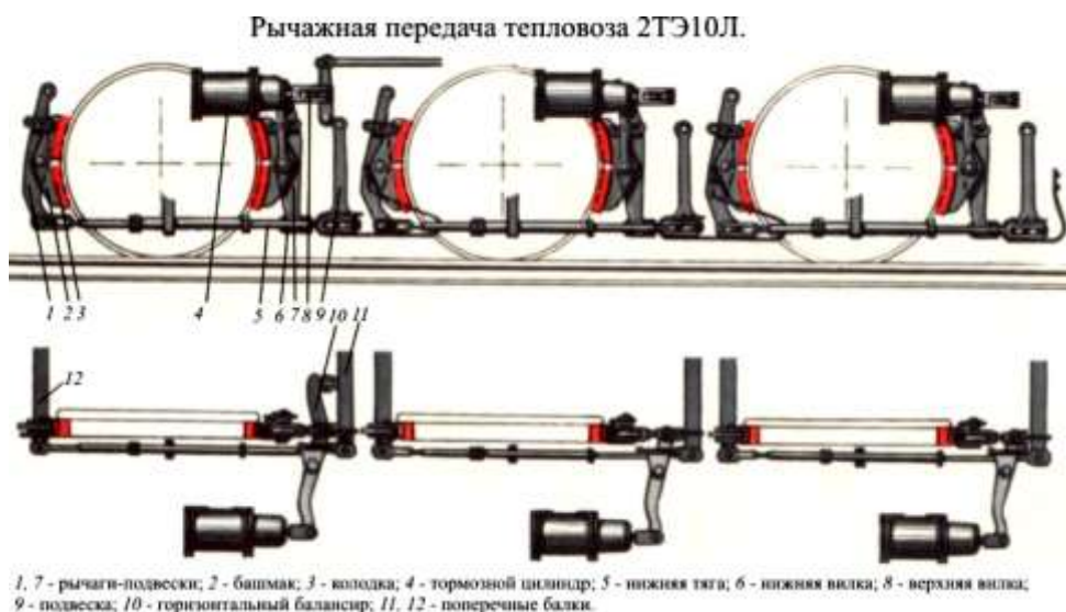
Рисунок 11. Рычажная передача тепловоза 2ТЭ10Л.
