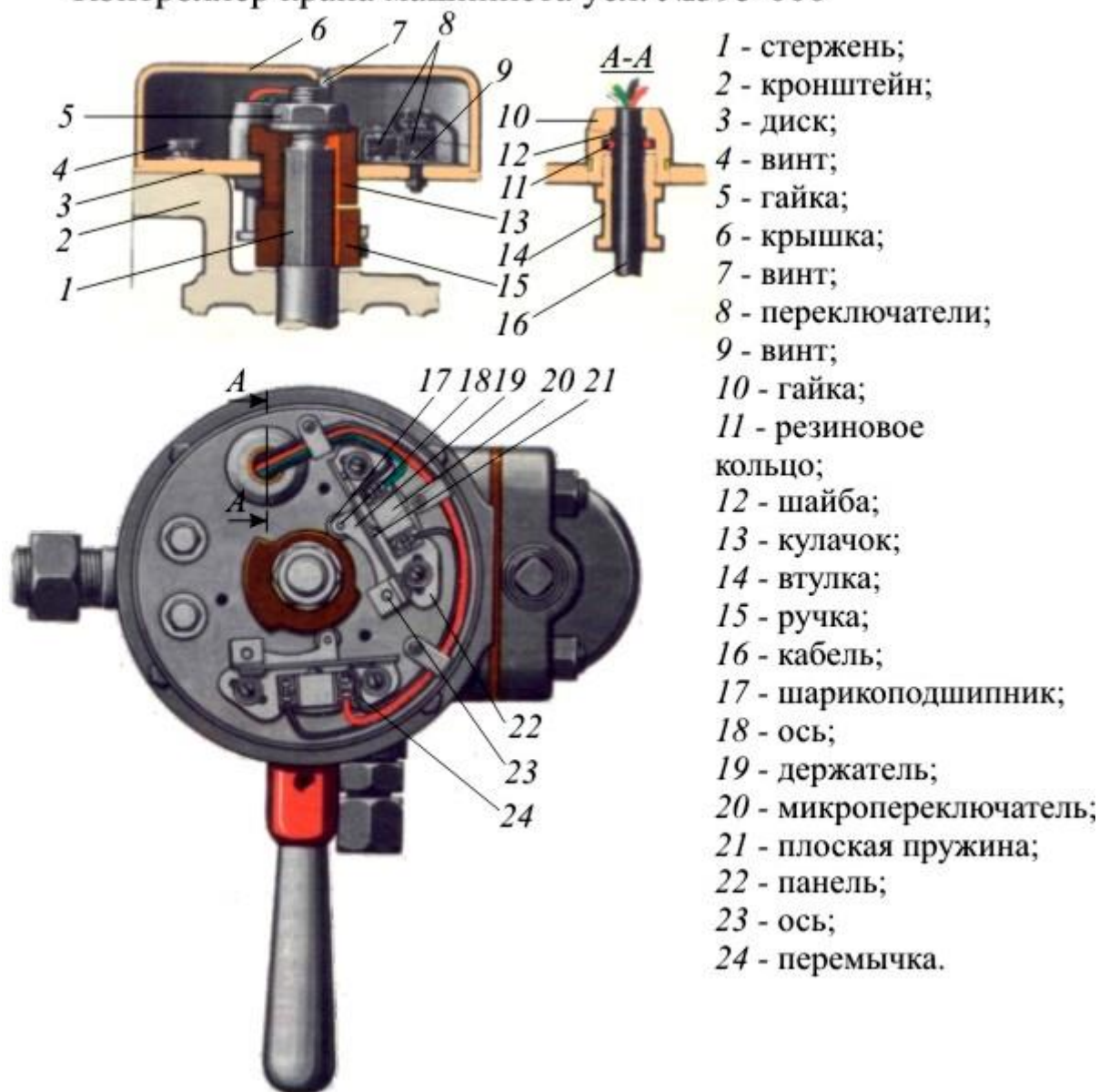
Рисунок 1. Контроллер крана машиниста усл. №395-000.
